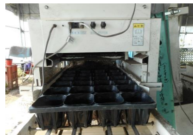
1ケースずつ挿入口にセット
